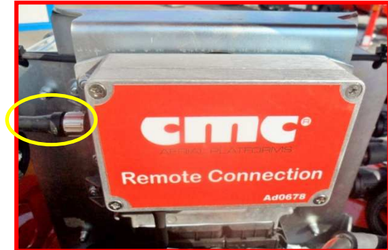
Figure 72 : boîtier de connexion à distance.
